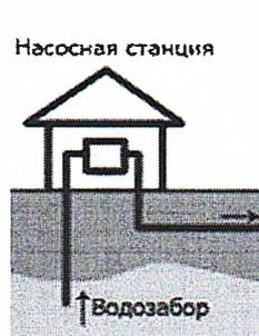
На станции водозабора очистка воды производится в виде обеззараживания воды, путём введения раствора гидрохлорида натрия, а также путем фильтрования через бункеры с цеолитом. Подготовлено оборудование для аэрации воды.
